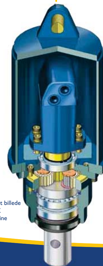
UNIK FUNKTION Non Dislodgement (ikke-løsne) aksel
