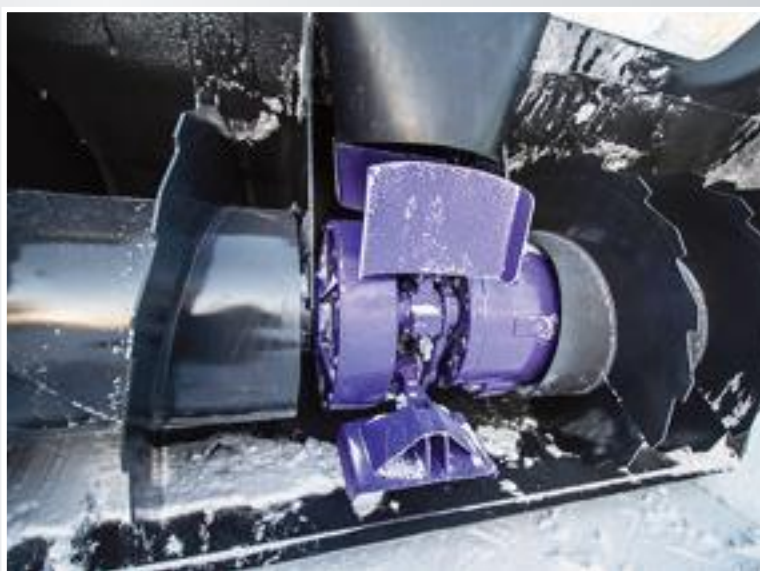
Skovlhjul – udformet, så det kaster sneen ud, hvilket minimerer risikoen for driftsstop.
